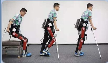
Fig. 1. The AIDER exoskeleton.
